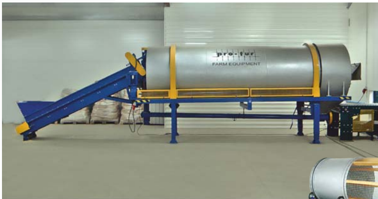
BĘBEN DUŻY do czyszczenia norek po uboju (600 – 800 szt. / godzinę z zamkniętym obiegiem trocin); produkcja PRO-FUR.
